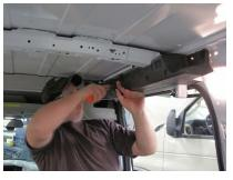
CAREFULLY REMOVE FOAM FROM ABOVE DRIVER SIDE AND PASSENGER SIDE SLIDING DOORS. MAKE SURE TO SAVE CLIPS IF YOU INTEND TO RE-ATTACH.
