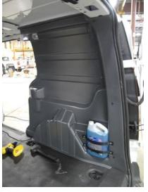
STORE A WINDSHIELD WASHER FLUID BOTTLE WITH THE STRAPS LOCATED ON THE PASSENGER PANEL.
