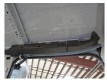
RE-ATTACH THE FOAM ABOVE THE SLIDING DOORS BY SNAPPING BACK BACK THE VELCRO HATCH INTO THE ORIGINAL HOLES. YOU WILL NEED TO DRILL A SIDE OF THE VAN. HOLE THROUGH THE LINER TO RE-ATTACH THE LAST CLIP.
